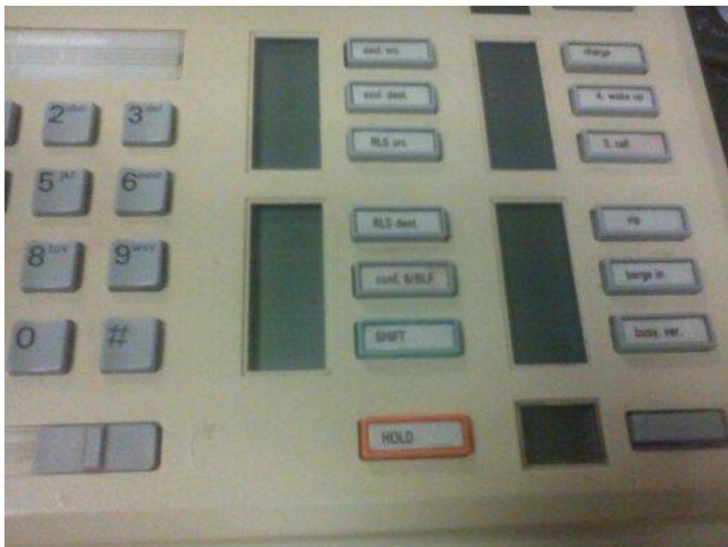
En esta parte de la imagen se puede observar una parte del teclado numérico, para que el teléfono nos de línea tenemos que presionar el número 9 y posteriormente marcar el número al cuál deseamos comunicarnos, debajo de los números ligeramente se alcanza a ver una imagen de un teléfono y a la izquierda del teléfono un deslizador, que sirve para controlar el volumen de la llamada.
